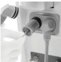
Filtro giratorio de doble sellado Filtro duplo selado rotativo
