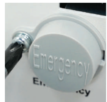
Interruptor de puerta de emergencia Interruptor de porta de emergencia
